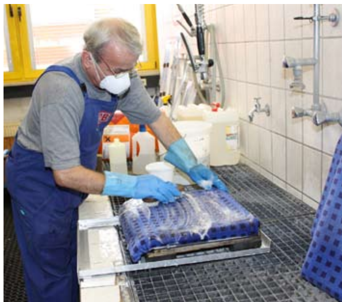
Reinigung: Mit spezieller Lauge und einer Wurzelbürste reinigt der Werkstattarbeiter die Sitze. Im Anschluss werden sie kalt abgespült und in die Trockenkammer gelegt.
